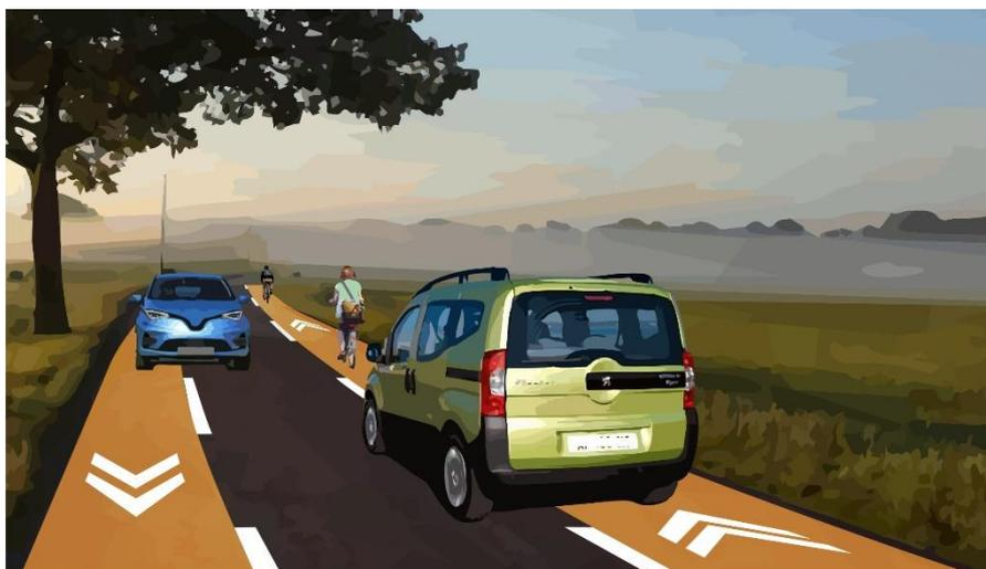
La chaussée à voie centrale banalisée est une chaussée étroite sans marquage axial dont les lignes de rive sont rapprochées de son axe. Les véhicules motorisés circulent sur une voie centrale bidirectionnelle et les cyclistes sur la partie revêtue de l'accotement
