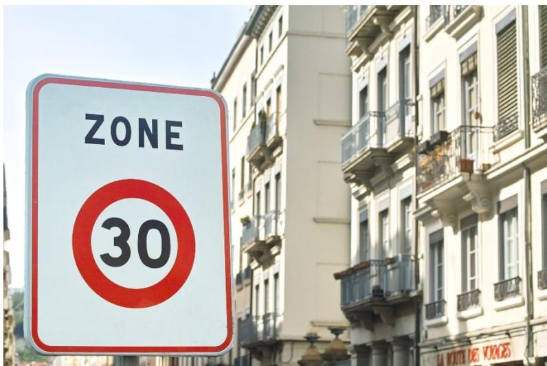
La zone 30 est une section ou ensemble de sections de rues où la vitesse des véhicules est limitée à 30 km/h. Toutes les chaussées sont à double sens pour les cyclistes sauf exception dûment justifiée par le gestionnaire. La zone doit être aménagée de manière cohérente avec la vitesse limite applicable.
