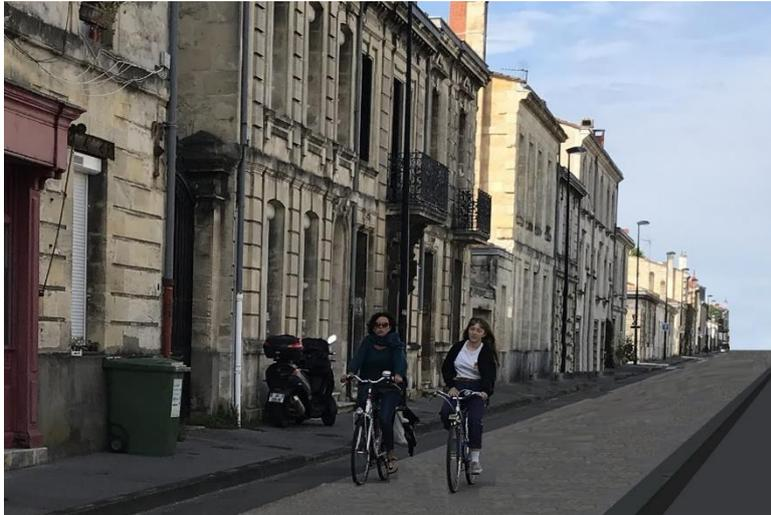
La vélorue est une section ou un ensemble de sections de voie appartenant au réseau cyclable structurant et accueillant un trafic motorisé exclusivement de desserte. Un nécessaire travail sur le plan de circulation des véhicules motorisés y garantit la suppression du trafic de transit et un trafic motorisé de desserte significativement faible.
